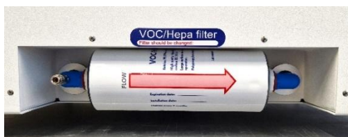
Kuva 12.3 Oikein asennettu VOC/HEPA-suodatin
