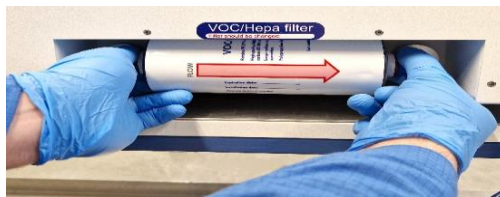
Kuva 12.2 VOC/HEPA-suodattimen asennus- ja poistomenettely
