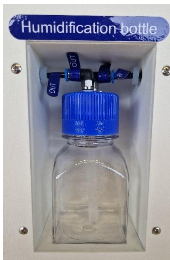
Kuva 22.1 Putkiliitäntä kosteutuspullossa ja Mini MIRI® Humidity-monitila-IVF-inkubaattorissa
